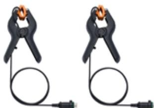
Set de sondas de temperatura de pinza con cable fijo para tuberías de 6 a 35 mm de diámetro. Tipo NTC, rango de -40 a +125°C Exactitud +/- 1°C (-20 a 85°C).
