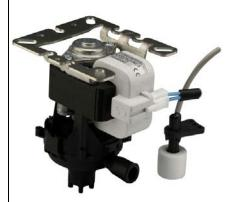
Alimentación eléctrica 230 V  $\sim$  50/60 Hz -14 W Caudal máximo 70 l/h a 60 cm Altura máxima de descarga 95cm (24 l/h a 95 cm)
